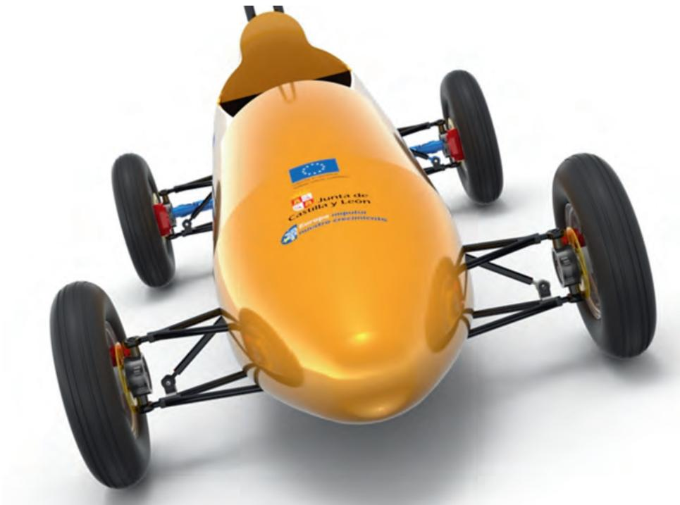
Vehículo eléctrico FARADAY V1 (incorpora dos motores, uno en cada rueda trasera y diferencial electrónico).
