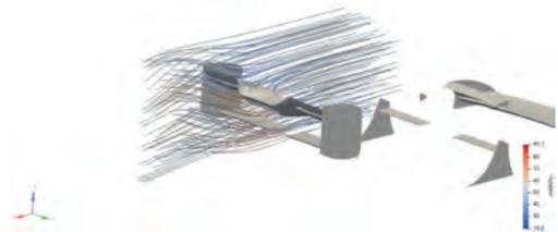
Vehículo RTULE- H2-21K, análisis aerodinámico CFD, turbulencias sobre la esquina izquierda del alerón trasero.
