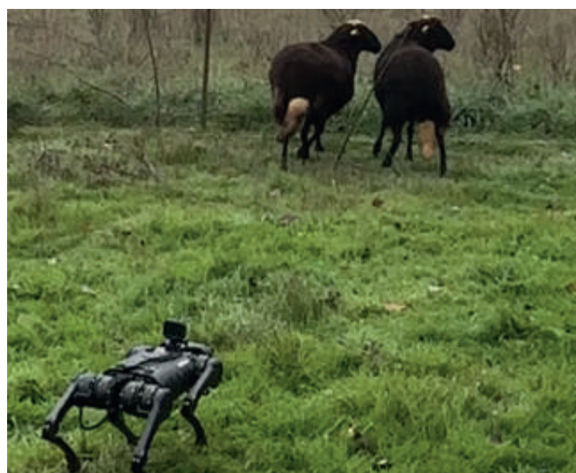
Uso de robots cuadrúpedos en ganadería extensiva para realizar labores de pastoreo.
