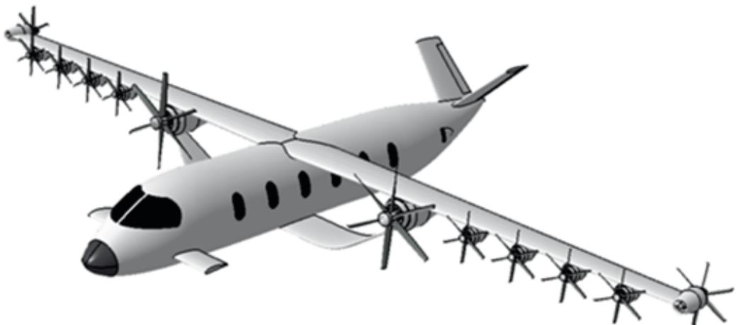
Configuración de diseño de la aeronave conceptual ZAP2.
